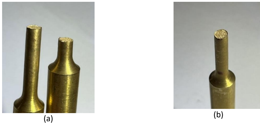
Gambar 13. Patahan kuningan ( brass ): (a) kedua sisi patahan tegak lurus, dan (b) permukaan patahan berbutir dan terang
