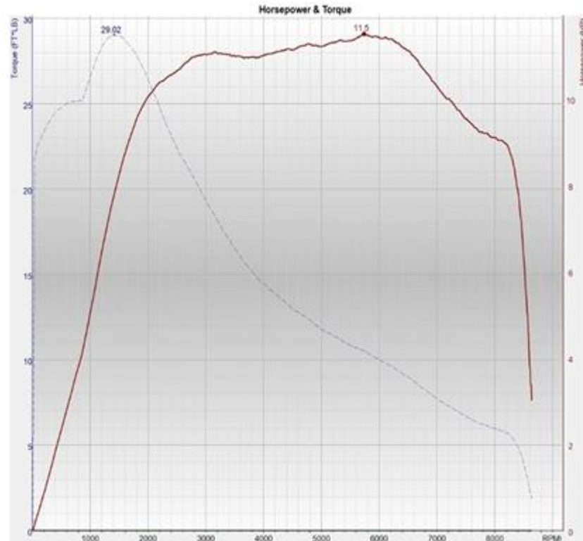
Gambar 2. Grafik torsi dan daya pada roller 13 gram
