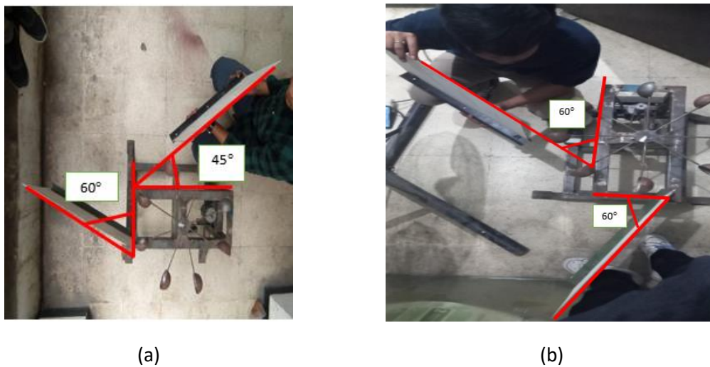
Gambar 4. Penempatan deflektor: (a) 60^\circ/45^\circ , dan (b) 60^\circ/60^\circ
