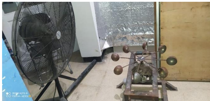
Gambar 2. Penempatan fan dan turbin
