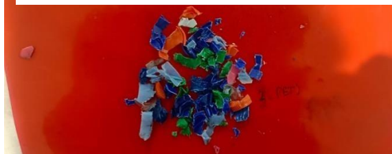
Gambar 8 Hasil Pengujian Cacahan Kedua PET Tutup Botol
