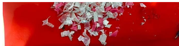
Gambar 14 Hasil Pengujian Cacahan Kedua PS Botol Yakult
