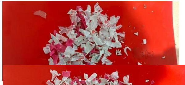
Gambar 13 Hasil Pengujian Cacahan Pertama PS Botol Yakult
