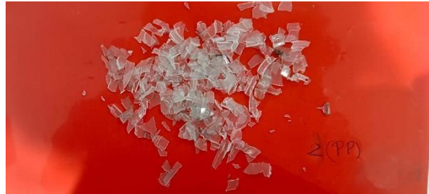
Gambar 12 Hasil Pengujian Cacahan Kedua PP Tutup Tupperware
