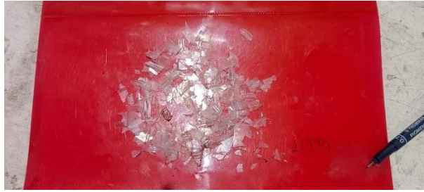
Gambar 11 Hasil Pengujian Cacahan Pertama PP Tutup Tupperware
