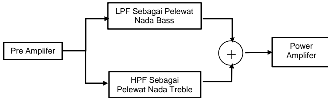
Gambar 6: Diagram blok penempatan pengatur nada dalam sistem penguat audio.
