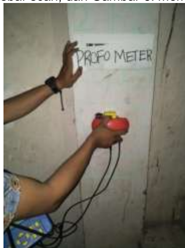
Gambar 6. Contoh pengujian RebarScan ( Profometer )
