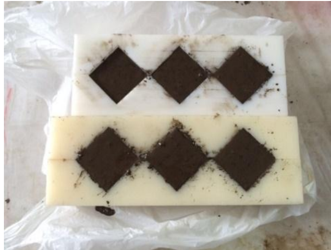
Gambar 4. Pencetakan mortar di mould kubus
