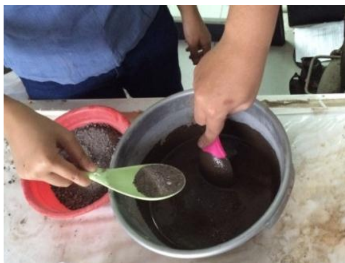
Gambar 3. Pencampuran aktivator, fly ash , dan agregat halus untuk membuat mortar
