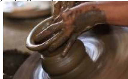
Gambar 11. Teknik Pembuatan Gerabah Putaran miring khas Melikan
