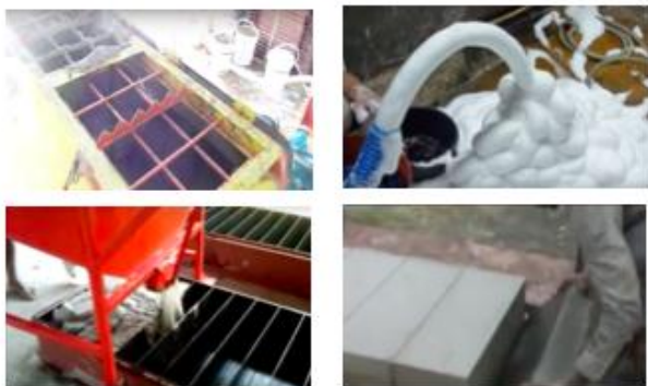
Gambar 5. Proses produksi bata ringan Sumber : Penulis
