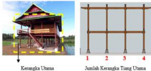
Gambar 2. Kerangka rumah bola eppa
