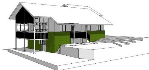
Gambar 2. 3D model bangunan Rumah Heinz Frick Peletakan ruang pada denah cenderung linier di kedua sisi bangunan yang dipisahkan oleh sebuah lorong pada bagian tengah. Ruang-ruang pada kedua sisi bangunan tersebut dihubungkan oleh bukaan berupa pintu tunggal maupun pintu geser lebar yang juga berfungsi sebagai dinding portabel. Sehingga antar ruang-ruang tersebut dapat dilewati manusia maupun aliran udara.
