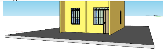
Gambar 4. Tebal teras rumah eksisting 20 cm
