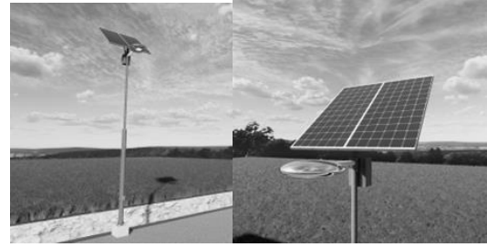
Gambar 6. Desain Lampu Panel Surya pada Parkir Pada akses menuju jembatan terdapat lampu berjumlah 7 dan pada bagian jembatan terdapat 3 buah lampu. Lampu diletakkan untuk memberikan penerangan yang cukup bagi area parkir, akses menuju jembatan, dan pada area jembatan.
