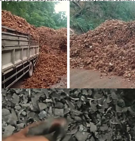
Gambar 3. Limbah Tempurung Kelapa Yang Diolah Menjadi Arang
