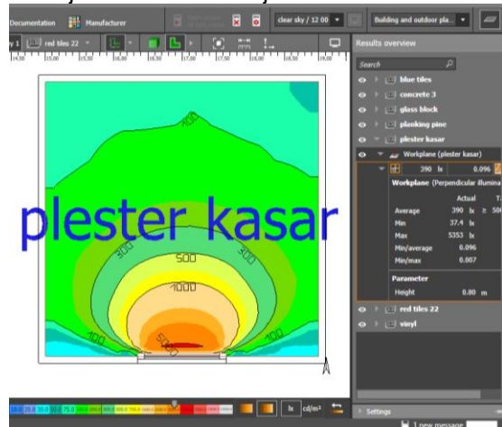
Pada ruang dengan plester kasar rata-rata intensitas cahayanya adalah 390 lux. Dengan nilai terbawah 37.4 lux dan tertinggi 5353 lux. Terlihat terjadi penurunan intensitas di bagian belakang ruang hingga 73 lux. Permukaan yang kasar mendifraksi pantulan cahaya yang mengenai bidang tersebut sehingga akan mengurangi intensitas cahaya.
