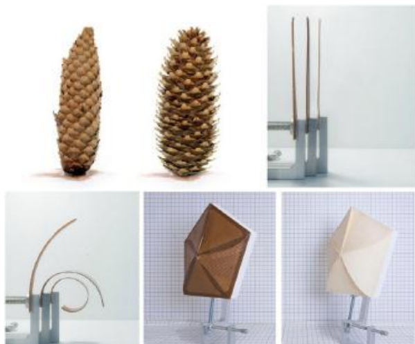
Gambar 2. Transfer prinsip biologis perubahan bentuk yang disebabkan oleh perubahan dimensi higroskopis dan anisotropik
