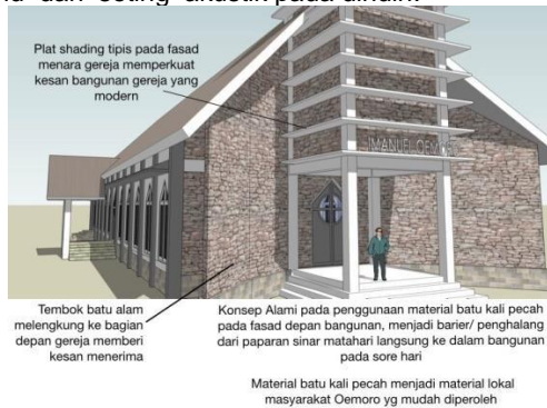
Gambar 7. Penggunaan Batu Alam Pada Fasad Gereja
